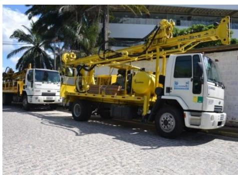
Figura - 29 Equipamentos do IPA de perfuração de poços
